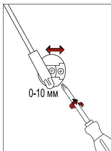
Открывание и закрывание двери может быть отрегулировано позицией лифта в креплении к боковине:
